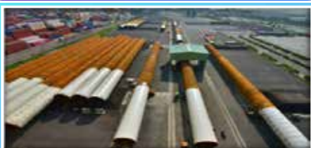
PP (Pin Piles) @ A5-D
